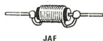
Fig. 5. Le impedenze di AF-JAF si otterranno avvolgendo sul supporto in ferrite da noi fornito una trentina di spire utilizzando filo smaltato da 0,15-0,18 mm.
