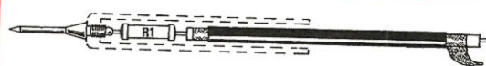
Fig. 4. Entro al puntale sonda andrà inserita la resistenza R1. Per collegare la sonda allo strumento occorrerà usare del cavetto schermato o del cavo coassiale molto flessibile.
